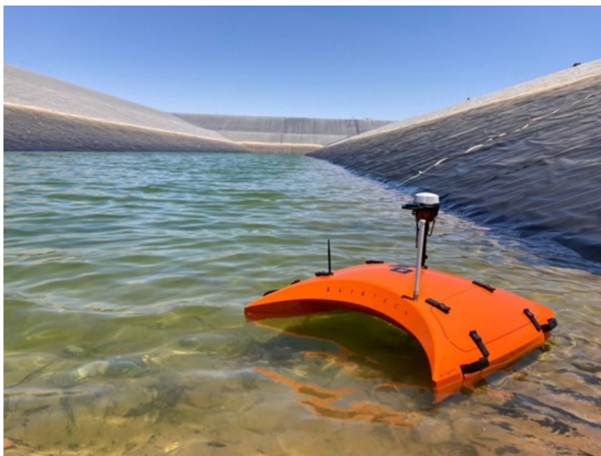
Obrázok 4: Plávajúci dron pri meraní tesnosti lagúny s toxickým odpadom
